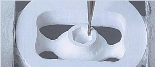
Zum Fräsen von Feindetails wie z.B. Innen- und Außensechskant des Abutments (Antirotation).
