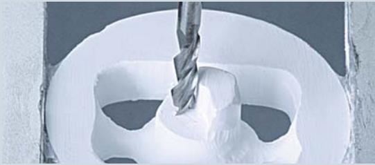
Zum Fräsen von parallelen Flächen wie z.B. von Abutments, Geschieben und 0° gefrästen Stegen, sowie von Schraubensitzen und Schraubenkanälen.
