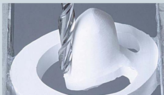
Zur Bearbeitung von Konuskronen und Primärteilen mit 2° Fräsung.
