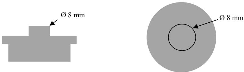
**Figura 4**, vista esquemática del indentador de PMMA.
