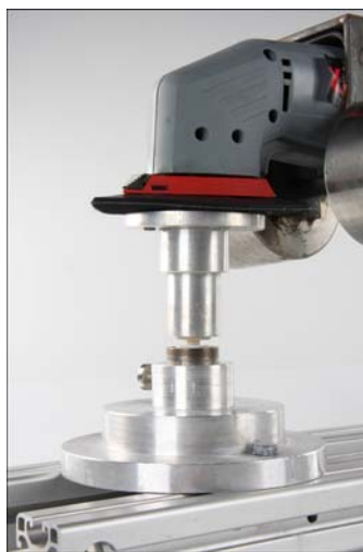
Figura 5 illustra il tipo di contatto tra la provetta e il corpo di attrito.
