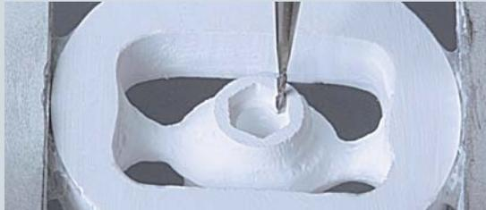
Per fresare particolari fini, quali ad. es. l'esagono interno ed esterno dell'abutment (antirotazione).
