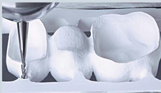
Per la lavorazione delle parti interne di corone particolarmente lunghe e per separare i punti di unione vestibolari.
