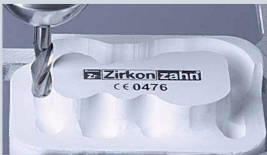
Per fresare i grezzi di zirconia (sgrossatura).
