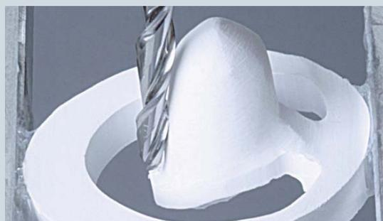
Per la lavorazione di corone coniche e parti primarie con fresatura di 2°.
