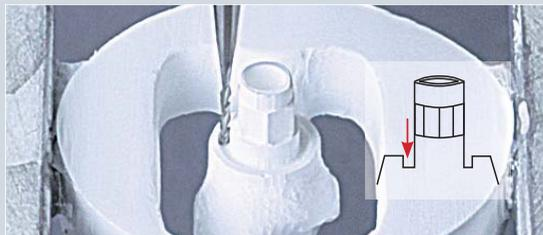
**In combinazione con il palpatore speciale 0,48 A:** per es. per fresare i particolari dei sottosquadri sugli abutment per i quali il palpatore 0,6 è troppo grosso.
