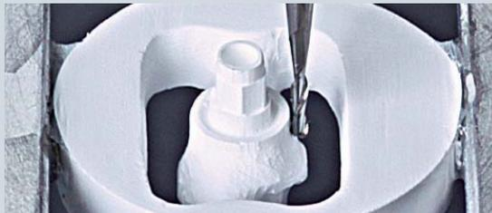
Per realizzare la parte esterna dell'abutment in collegamento con il palpatore frizionante 1 L F+. In tal modo il margine rimane leggermente più grande.
