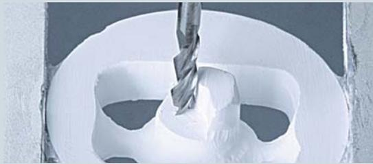
Per fresare superfici parallele, quali, ad esempio, abutment, attacchi e attacchi a barra fresati a 0°, nonché sedi e canali di vite.
