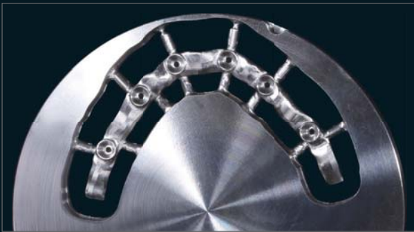
Alles CAD/CAM gefräst: Modelle, Prototyp, Titansteg, Zirkonstruktur mit Schraubenkanalgewinden und Versiegelungsschrauben
