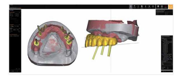
La restauration finale est modélisée numériquement à l'aide du prototype provisoire à long terme. La base de la construction de l'armature de la restauration maxillaire dans le logiciel Zirkonzahn. Modellier est à nouveau le pool de données avec toutes les informations spécifiques au patient.
