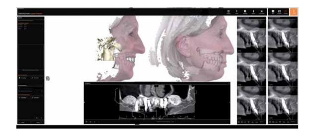
Numérisation et transfert correct de la situation du patient à l'aide d'un scanner modèle et d'un logiciel de numérisation. La planification des implants a également été réalisée à l'aide de scans faciaux en 3D dans le logiciel Zirkonzahn.Implant-Planner.
