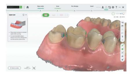
Die grünen Markierungen zeigen an, dass der Bereich nicht gescannt wurde; die grauen Markierungen weisen darauf hin, dass der Scan von geringer Qualität ist und dass zusätzliche Scans durchgeführt werden sollten, um ein Maximum an Informationen zu erhalten.
