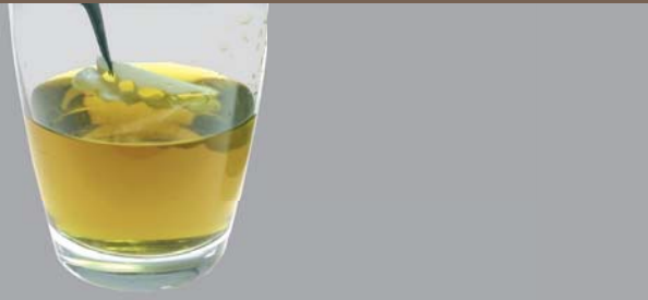
Tauchvorgang - 5 Sekunden in Färbeflüssigkeit eintauchen
