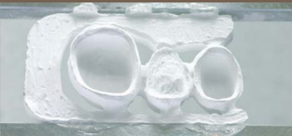
Fertig ausgefräste Arbeit - bereit zum Herausschneiden
