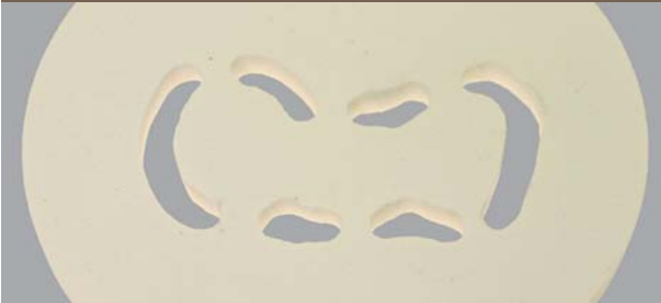
Mit Hartmetallfräse ausschleifen
