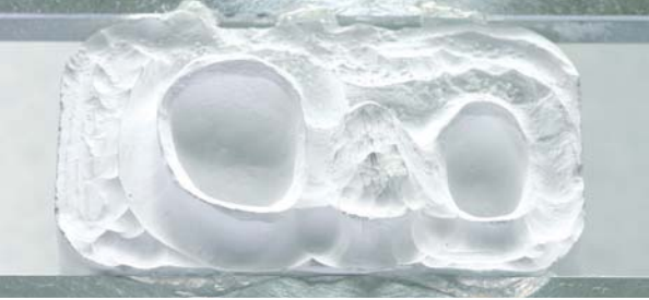
Mit 2er Fräse die Form genauer ausfräsen
