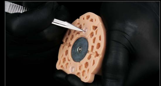
Sollten Kunststoffüberschüsse in den beiden Anti-Rotations-Aussparungen in den Modellen auftreten, werden diese mithilfe eines Skalpells entfernt.
