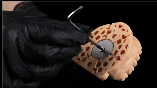
Die passenden Magnetbleche werden in die Modelle eingesetzt und fixiert. Falls gewünscht, können die Magnetbleche auch eingeklebt werden.
