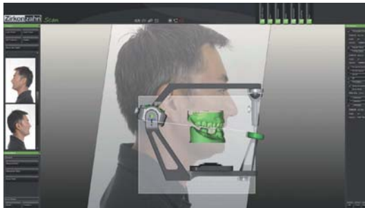
Abb. 1: Ideale Situation: Die Lage des Oberkiefers im Schädel wurde 1:1 in den Artikulator und in die CAD-Software übertragen.
