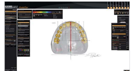
Abb. 24: Positionierung der restlichen Zähne ausgehend von der absoluten Mitte und Modellation im richtigen Größenverhältnis zueinander.
