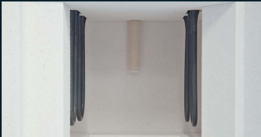
Brennraum des Zirkonofen 700 mit MoSi 2 Heizelementen
