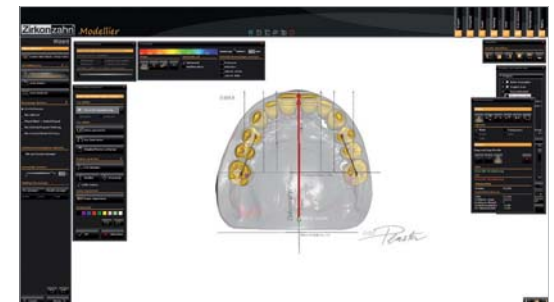
Fig. 24: Posicionamiento de los dientes restantes partiendo de la línea media absoluta y modelado con las proporciones correctas unos respecto a otros.
