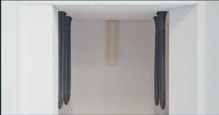
Chambre de combustion du four de frittage Zirkonofen 700 avec éléments chauffants MoSi 2
