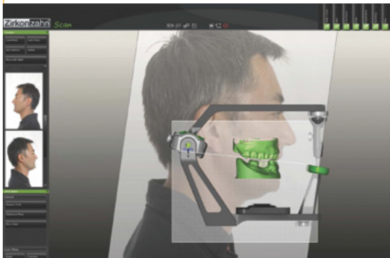
Abb. 1: Ideale Situation: Die natürliche Position des Ober- und Unterkiefers wurde 1:1 in den Artikulator und in die CAD-Software übertragen.
