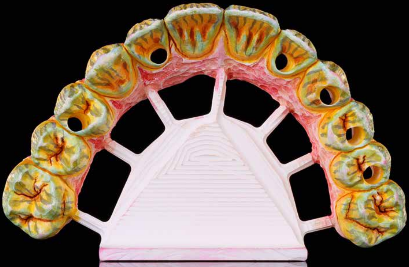
30 - 36 Die aus Prettau Zirkon gefräste Oberkiefer-Suprastruktur wurde vor dem Abtrennen des Sinterfußes (verhindert den Verzug des Objekts beim Dichtsintern) mit den Colour Liquid Prettau Aquarell Farben individuell voreingefärbt
