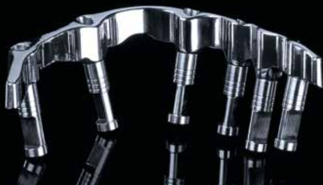
24 & 25 Nach dem Heraustrennen des Titanstegs aus dem Materialblank wurde er im Parallelometer mit einer 2°-Fräse nachgearbeitet und mit entsprechenden Polierkörpern auf Hochglanz gebracht
