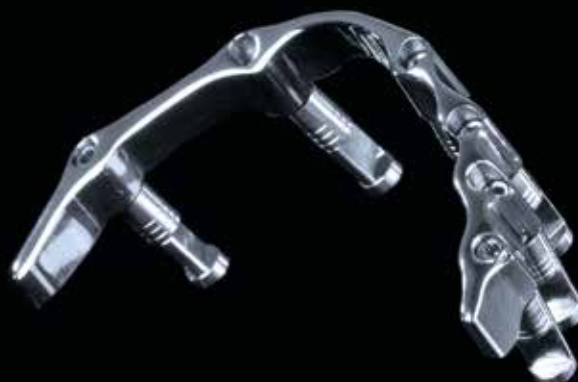
24 & 25 Nach dem Heraustrennen des Titanstegs aus dem Materialblank wurde er im Parallelometer mit einer 2°-Fräse nachgearbeitet und mit entsprechenden Polierkörpern auf Hochglanz gebracht
