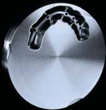
23a & b Der Titansteg wurde im Fräsgerät M1 Wet Heavy Metal mit einem Winkel von 2° aus dem Blank herausgefräst. Die rechte Abbildung zeigt die Maschine beim Bearbeiten eines anderen Werkstücks, verdeutlicht aber ganz gut den Anstellwinkel
