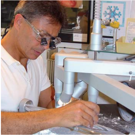
Kopier-Fräsvorgang in 5 Achsen
