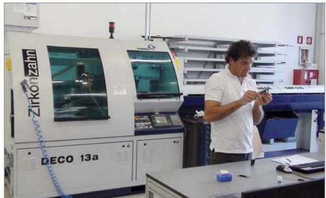
Abb. 8: Fräsmaschine für Implantataufbauten.
